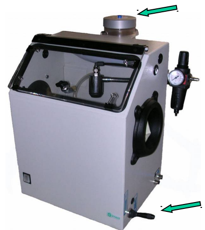
(cod. APRIM1 ): PRIMA/1 ca. 32 x 39 x 44 cm - ca. kg 10 con l'aggiunta di 1 modulo per microabbatura with an additional tank for fine sandblasting avec un réservoir additionnel pour microsablage mit zusätzlichem Tank zum Feinsandstrahlen
